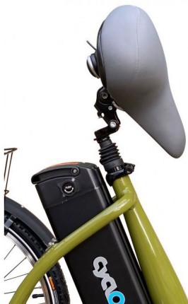
Tige de selle basculante à suspension
