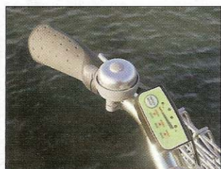
Un boîtier, installé sur le guidon, indique la charge de la batterie ainsi que le niveau d'assistance.
