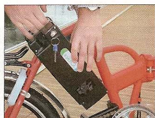
La batterie qui alimente le moteur électrique de 240 watts se retire pour être rechargée.
