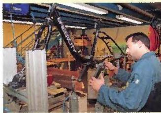
*L'installation du cadre du Greencity Madrid (Carrefour) sur le banc d'essai permet d'en tester la structure.*
