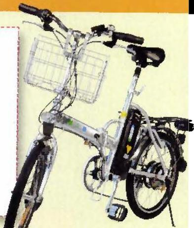
**+** **Les plus :** ce VAE pliant dispose de trois niveaux d'assistance ("eco", "mid" et "max"), qui permettent de doser l'effort. On appréciera particulièrement sa batterie lithium-ion de 24 V-10 Ah, qui se recharge rapidement (1 h 45) pour une autonomie importante (50 km). Il présente de bonnes performances sur le plat et reste acceptable en côte. Un bon point au chapitre équipement avec un panier, un porte-bagages, un antivol et un système permettant de retirer facilement la selle.
